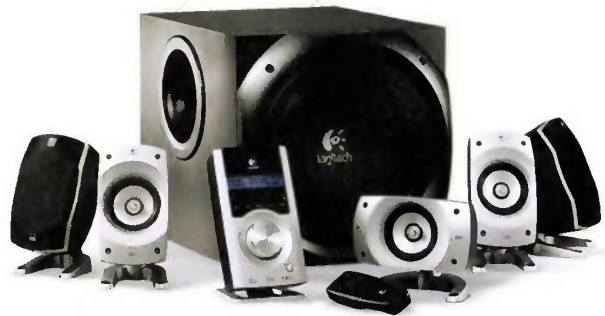
Suivant son diamètre, un haut-parleur est plus à l'aise pour sortir des sons aigus (1 à 3 cm), médians (10 à 16 cm) ou graves (20 à 38 cm). Faute de place, les kits PC sont en général équipés de petites membranes qui doivent à la fois assurer médiums et aigus. Les enceintes de salon, plus volumineuses, ont plus de haut-parleurs et sont ainsi mieux adaptées à la reproduction des sons de tous types.
